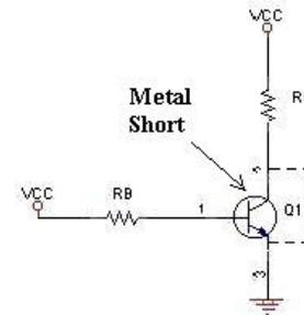
**Gambar 4.** Transistor Pada Saat Keadaan Saturasi
