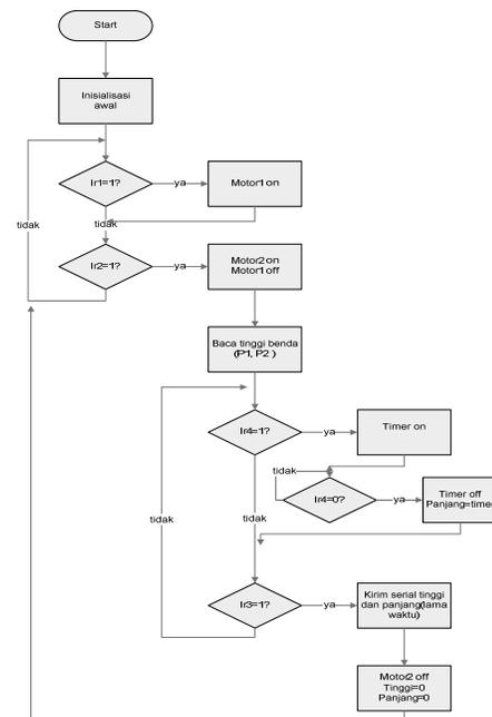
Gambar 23. Diagram Alir Program Software Pada Mikrokontroler
