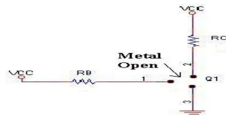
**Gambar 5.** Transistor Pada Saat Keadaan *Cutoff*
