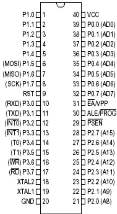
Gambar 1. Konfigurasi Pin AT89S51<sup>[1]</sup>
