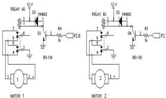
Gambar 22. Rangkaian Driver Motor
