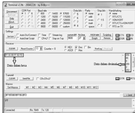
Gambar 22. Hasil pengujian RS-232
