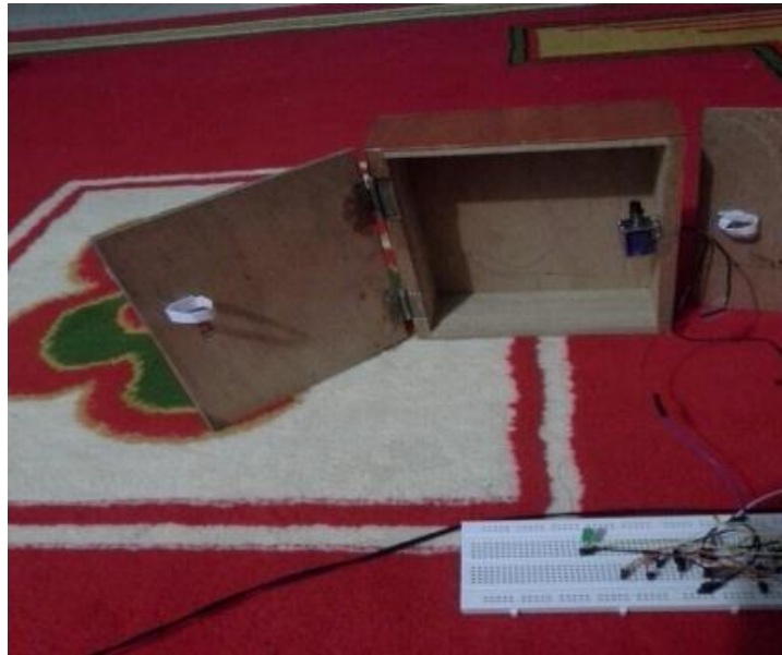
Gambar 5.7 Rangkaian Aduino Dengan Breadboard Menunjukkan Pintu Terbuka.
