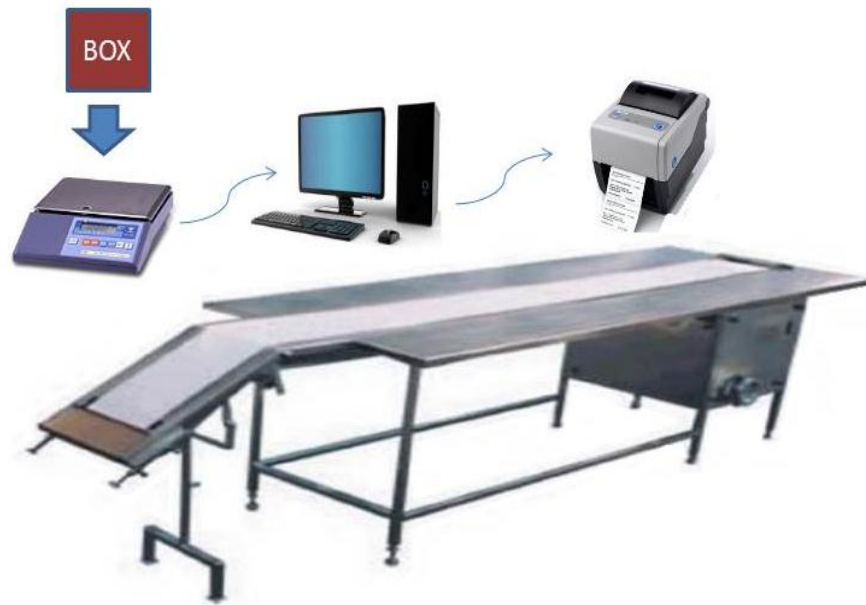
Gambar 16. Penggunaan Hardware – Sistem Aplikasi Timbangan
