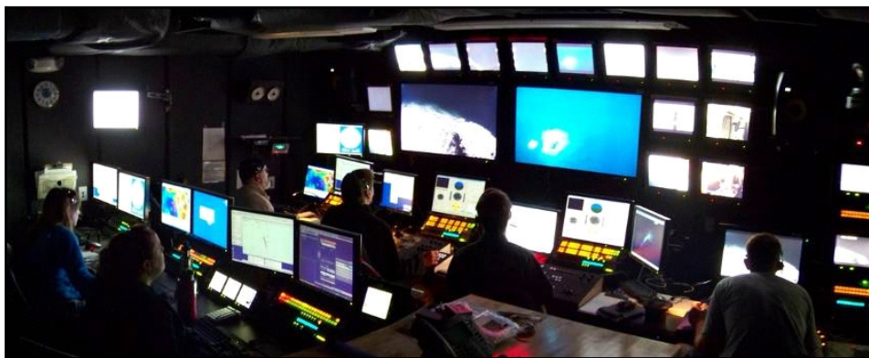
Gambar 4. Control room di atas kapal Okeanos Explorer yang memperlihatkan gambaran langsung dari bawah laut hasil penjelajahan ROV
