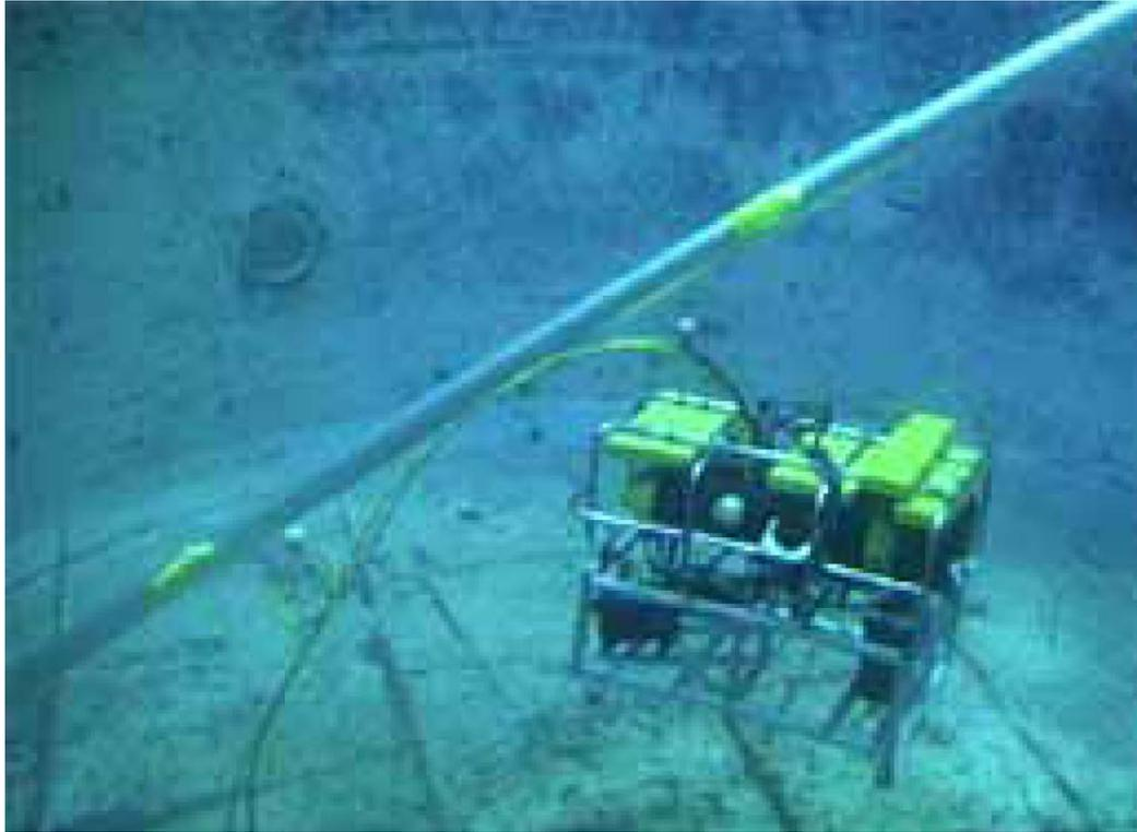
Foto 7. Penggunaan Remotely Operated Vehicle (ROV) pada inspeksi pipa migas (Edwards, 2007 )
