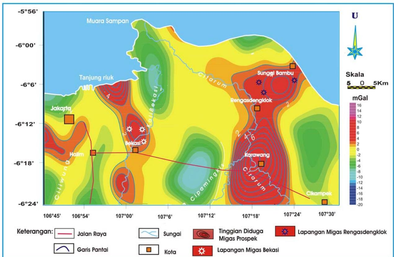
Gambar 2. Peta prospek berdasarkan dimensi antiklin kontur 5 -16 mGal diperlihatkan tinggian Bekasi lapangan migas baru, dan tinggian Rengasdengklok. Didaerah tinggian tersebut Pertamina akan melakukan pemboran 21 lokasi tahun 2010 pada daerah Bekasi, Rengasdengklok, Karangbaru (Karawang) dan Cimalaya (Subang) daerah Cekungan Jakarta dan sekitarnya Jawa Barat (Saultan Panjaitan., 2009).
