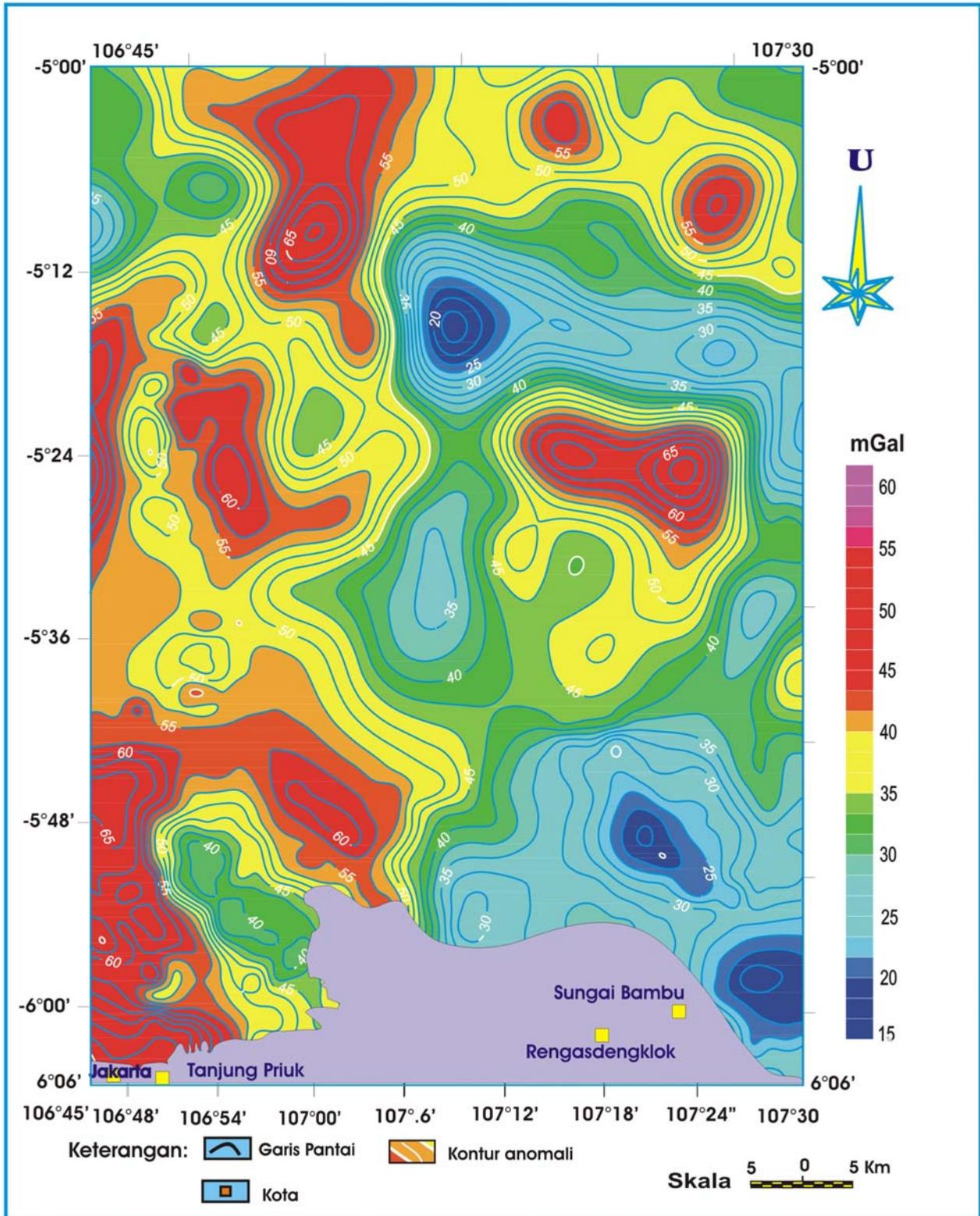
Gambar 4 Peta Anomali Bouguer memperlihatkan Tinggian regional (warna merah) daerah rendahan (warna biru hijau) secara umum struktur regional yang terbentuk arah Utara - Selatan dan Timur-Barat yang dicerminkan oleh kelurusan-kelurusan anomali daerah lepas pantai Utara Jakarta.
