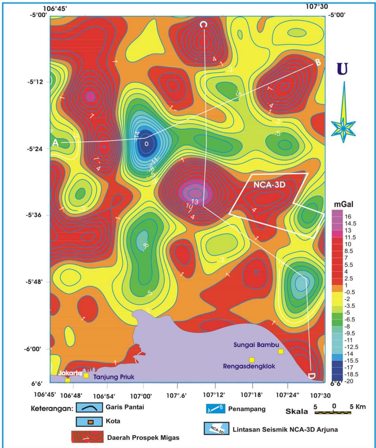
Gambar 5. Peta Anomali Sisa daerah prospek migas berdasarkan dimensi antiklin dan nilai kontur anomali yang memperlihatkan tinggian (warna merah) ditafsirkan sebagai batuan reservoir perangkat struktur migas dan rendahan anomali (warna biru hijau) membentuk sinklin dilepas pantai Utara Jakarta.
