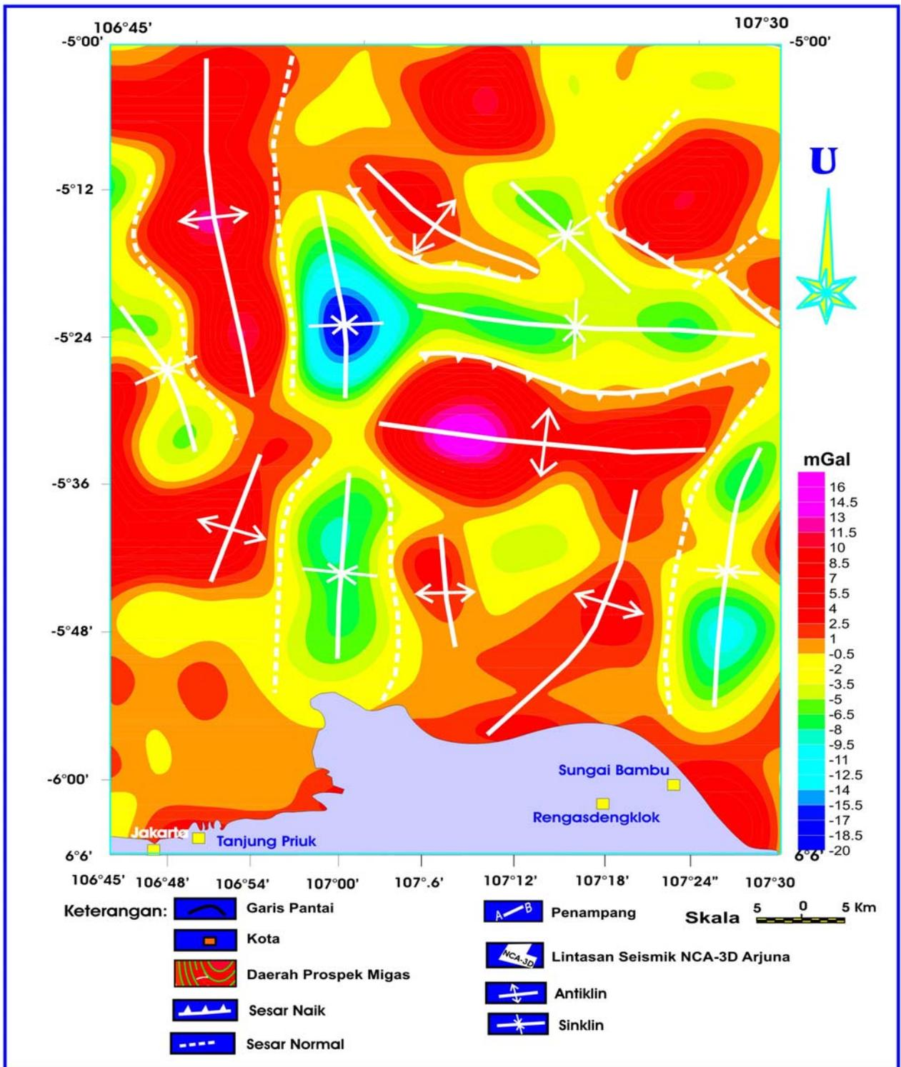
Gambar 10. Peta struktur yang memperlihatkan tinggian dan rendahan dibatasi oleh sesar normal pola Utara- Selatan dan sesar naik arah Timur - Barat struktur tinggian tersebut identik dengan penampang seismik lepas pantai yang membentuk pematahan bongkah pada batuan alas lepas pantai Utara Jakarta, Jawa Barat.
