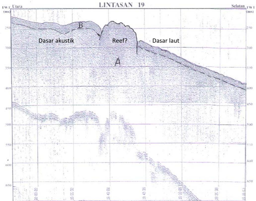
Gambar 5. Interpretasi Rekaman Seismik di Lintasan L19
