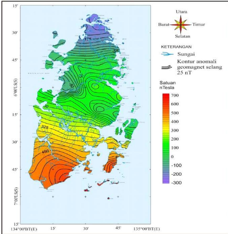
Gambar 11. Peta kontur anomali geomagnet Kepulauan Aru
