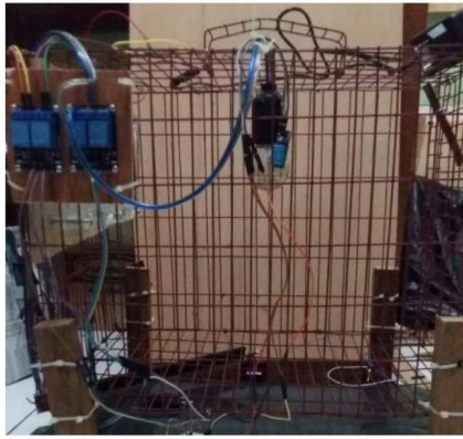
Gambar 6. Purwarupa kandang kelinci dengan komponen relay dan DHT11
