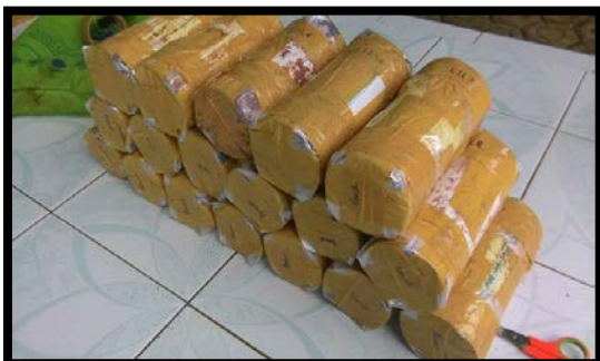
Gambar 2. Tabung Sampel Tanah Undisturbed Sumber : Dokumentasi Penulis
