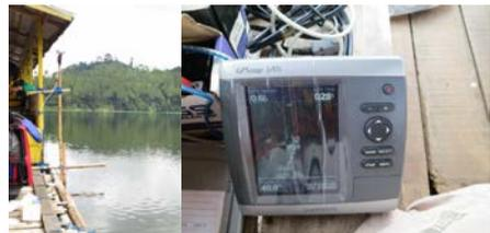
Gambar 3. Seperangkat Alat Sounding (Dokumen Pribadi, 2014)
