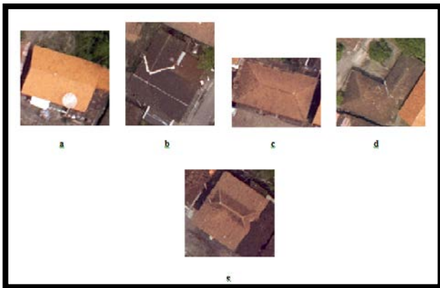
Gambar 2 Kenampakan atap rumah dari Foto udara ortho, Gambar (a) adalah tipe atap rumah pelana ( gable roof ), gambar (b) adalah tipe atap rumah cross gabled roof (pelana modifikasi), gambar (c) adalah tipe atap rumah limas ( hip roof ), gambar (d) adalah tipe atap rumah cross hipped roof (limas modifikasi) dan gambar (e) adalah tipe atap joglo
