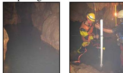
Gambar 4 Kondisi aliran Gua Gilap pada bulan April 2006 (a) Pengukuran Debit aliran Gua Gilap pada bulan April 2006 (b)
