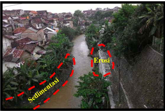
Gambar 4 Proses erosi dan sedimentasi pada alur Sungai Code penggal Banteng-Gondolayu DI Yogyakarta (Kel. Cokrodiningratan x : 430592 y : 9140145, 2015) Sumber : Foto lapangan (2015)
