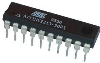
Sumber : Elektronika (2013) Gambar 2. Mikrokontroler ATtiny 2313
