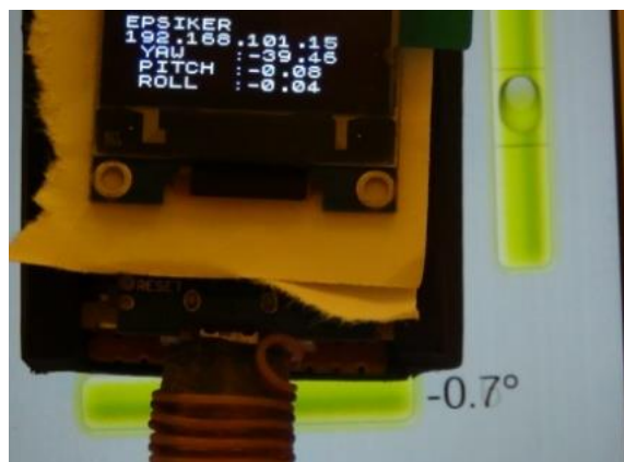
Gambar 5. Kalibrasi menggunakan waterpass .
