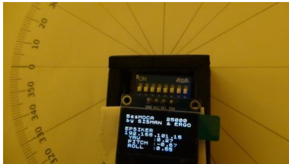
Gambar 6. Kalibrasi menggunakan busur derajat
