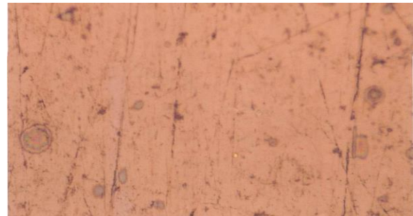
Gambar 5. Struktur Mikro AISI 304 kondisi T_1 = 600^{\circ}\text{C} , holding time 30 menit, media pendingin air. Pembesaran 100x.
