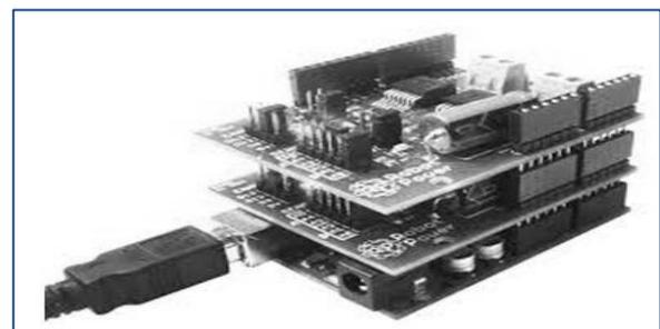
**Gambar 3 Arduino (Paling Bawah) dan Dipasang 2 Shield**
