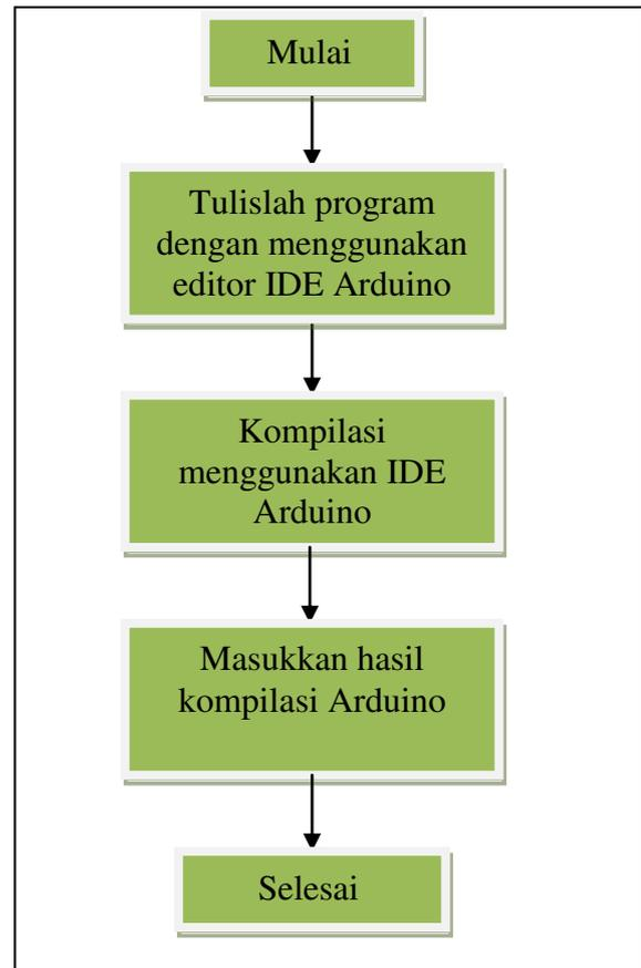
**Gambar 16. Flowchart Proses Pengisian Program ke Mikrokontroler**
