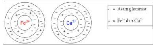
Gambar 2. Mekanisme Koagulasi dengan Lapisan Difusi Ganda
