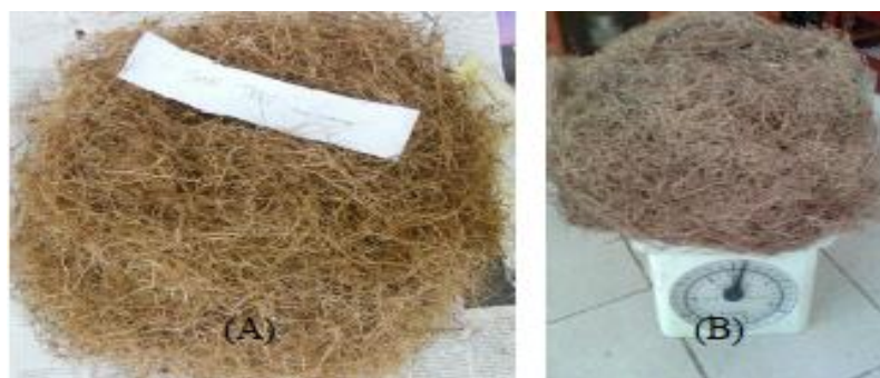
Gambar 1. Serat TKKS dengan perlakuan Perebusan (A) dan Pengukusan (B)
