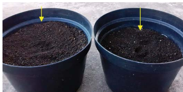
Gambar 3. Tanah dicampur 0,5% hidrogel (kiri) dan tanpa hidrogel (kanan) yang dijenuhi air.
