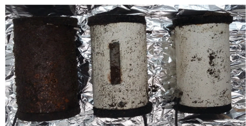
Gambar 8. Kondisi spesimen di dalam media tanah pasir dengan kandungan air 25 % dan resistivitas 82,46 Ohm.m
