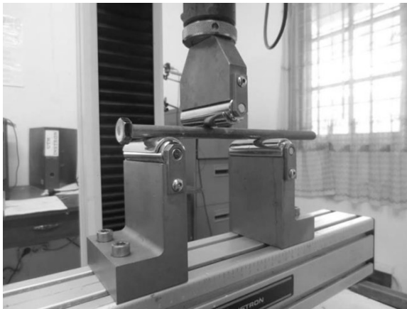
Gambar 1. Pengujian kekuatan leleh lentur baut
