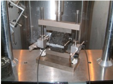
Gambar 2. Konfigurasi uji kelelahan ( fatigue )
