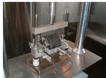
Gambar 1. Konfigurasi uji ITSM
