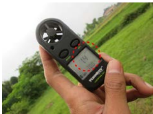
Gambar 5. Pengukuran kecepatan angin dengan alat anemometer .
