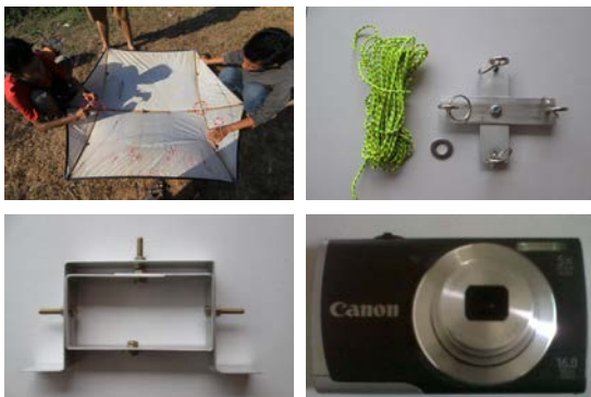
Gambar 1. Alat – alat yang digunakan antara lain layang – layang rokkaku, picavet, rig kamera dan kamera pocket canon 2500 IS.
