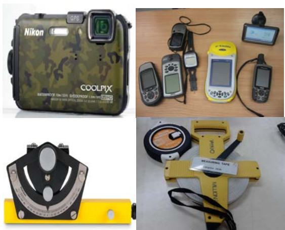
Gambar 1. Beberapa alat yang digunakan antara lain pita ukur, abney level, GPS dan kamera.
