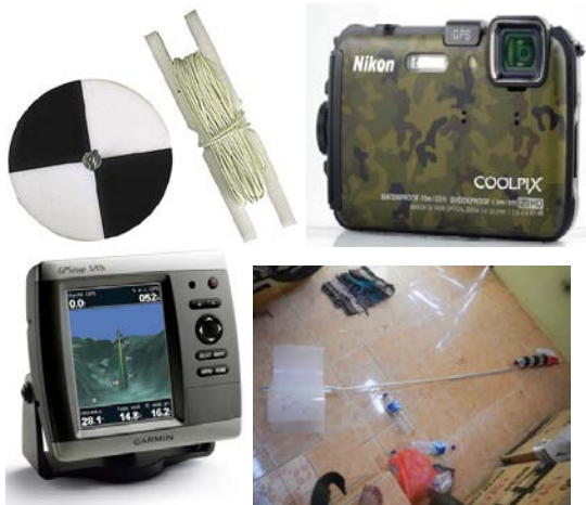
Gambar 1. Beberapa alat yang digunakan antara lain secchi disk, kamera tahan air, echosounder, current drouge.
