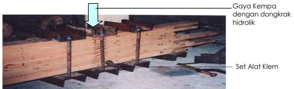
Gambar 2. Sketsa pembuatan balok glulam
