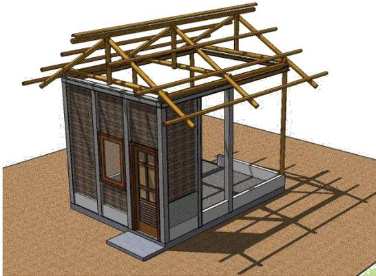
Gambar 5. Perspektif Model Konst. Dinding Bambu (Disain Model, 2010)
