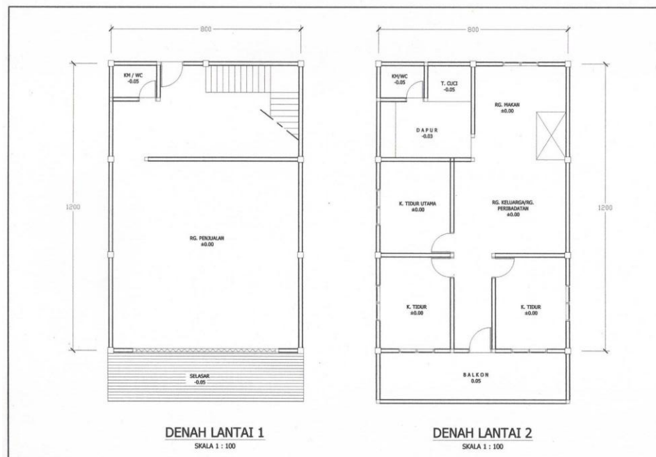
Gambar 6 Denah Bangunan Pecinan Sistem Ruko pada Umumnya
