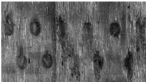
Gambar 5. Spesimen kekerasan kayu ebony
