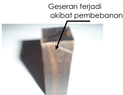
Gambar 2. Spesimen uji setelah diuji
