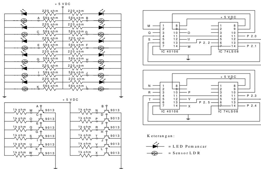
Gambar 5. Skematik modul LED pemancar dan sensor LDR.
