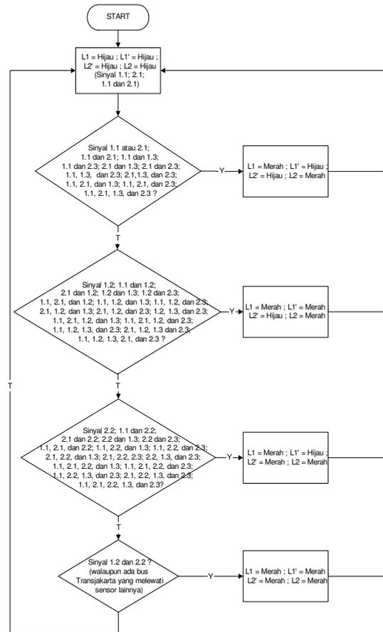
Gambar 8. Diagram alir perancangan perangkat lunak untuk mikrokontroler.
