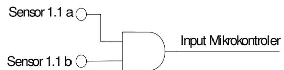
Gambar 3. Pemakaian gerbang AND untuk mengurangi kesalahan pendeteksian.
