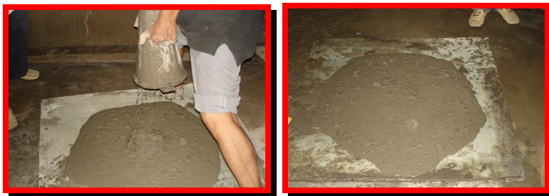
Gambar 3. Pengujian Keleccakan Aliran SCC dengan Konus Keleccakan ( Slump-Cone Test )
