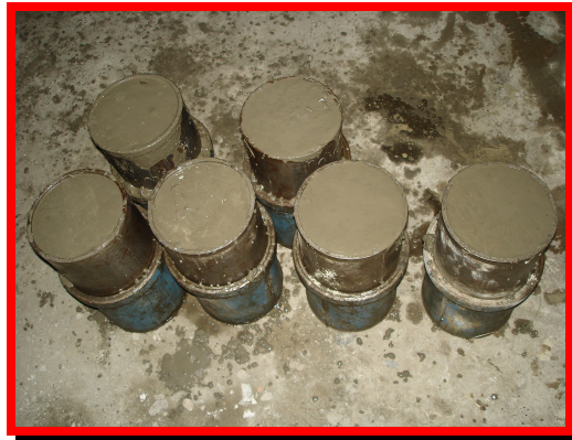
Gambar 5. Hasil Pencetakan "Fresh SCC" Tanpa Pemadatan Mekanik
