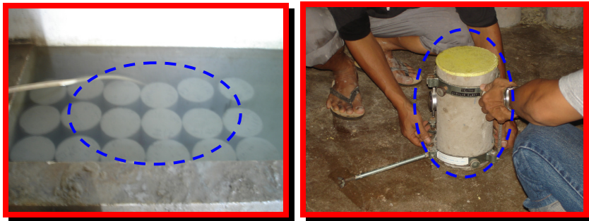
Gambar 6. Fisik "Hardened SCC" dalam Curing dan Persiapan Pengujian Kuat Tekan
