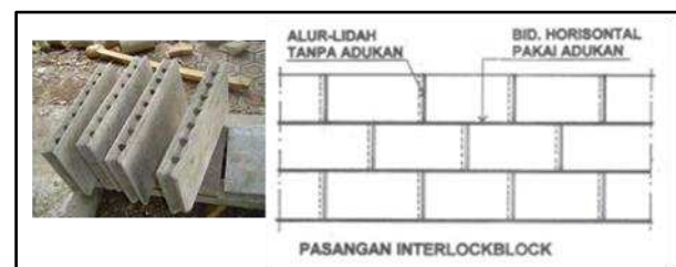
Gambar 2. Bentuk dan pemasangan interlockblock Sumber: WS. Witarso, 2007
