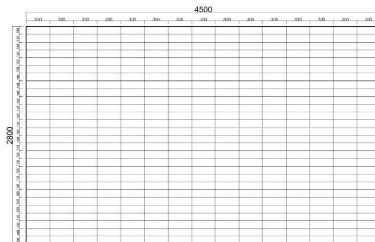
Gambar 12. Analisis Kelipatan Modul Dasar pada Dinding 2,8 x 4,5
