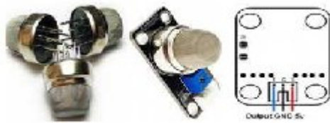
Gambar1. Penampang atas sensor MQ 2
