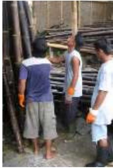
*Gambar 3.6 Cara pengawetan bambu dengan solar*
