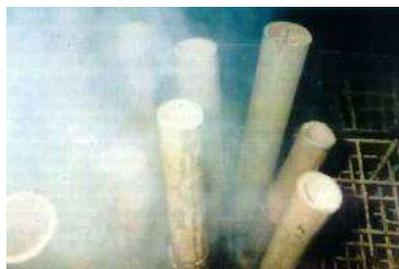
*Gambar 3.5 Cara pengawetan bambu dengan pengasapan*
