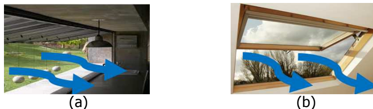
Gambar 4. (a) Penghawaan Melalui Fasad, (b) Penghawaan Melalui Atap
