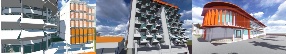
Gambar 1. Jenis Sirip Penangkal Sinar Matahari
