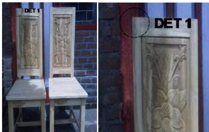
Gambar 16. kursi jepara yang memakai sistem sambungan lubang dan pen (sumber,dok. pribadi)
