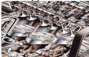
Gambar 3. Mekanisme katup pada mobil. Sumber: [www.pikiran-rakyat.com/](http://www.pikiran-rakyat.com/)
