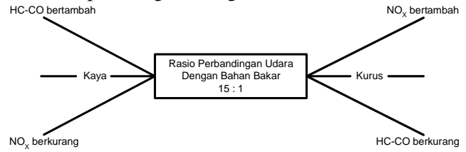
Gambar 8. Rasio Perbandingan Antara Udara dengan Bahan Bakar Terhadap Kadar HC, CO, NO x
