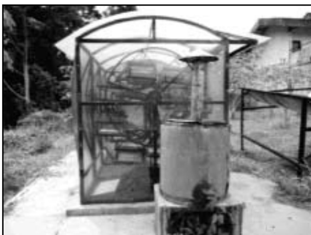
Gambar 1. Alat pengering Efek Rumah Kaca- hybrid tipe rak berputar
