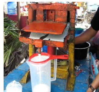
Gambar 1. Alat Pemeras Kelapa Parut Aktual
