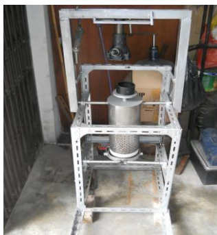
Gambar 5. Rancangan Alat Pemeras Kelapa Parut Usulan
