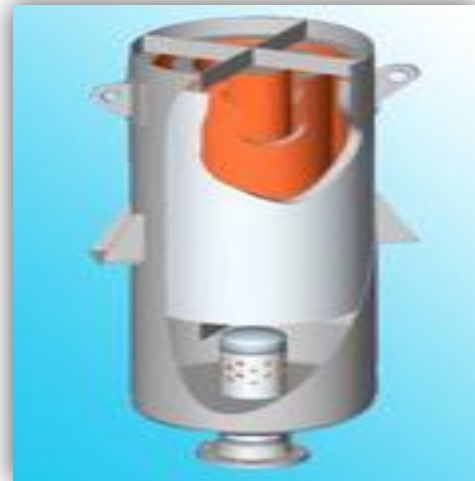
Gambar 6. Salah Satu Perbaikan pada Sumber Bising dengan Silencer pada Vent Gas
