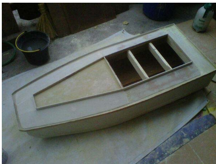
Gambar 3. Master cetakan untuk rekonstruksi pertama (gagal)
