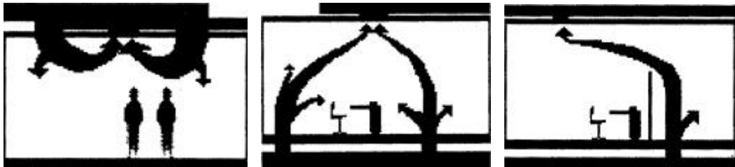
Gambar 4. Sistem ventilasi berasal dari langit-langit. Sistem ventilasi didistribusikan dari lantai. Ventilasi terbatas oleh partisi. (Pilatowicz, 1995:84)
