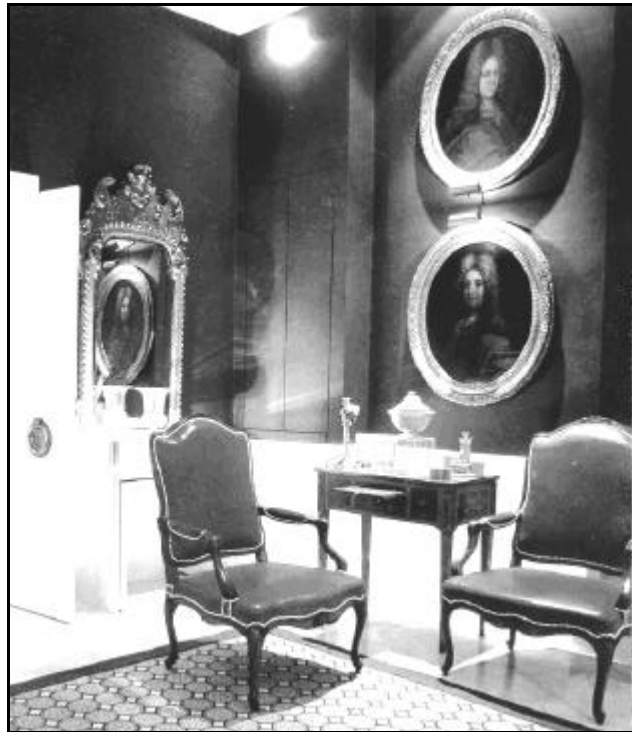
Gambar 8. Sebuah contoh penonjolan obyek di sudut ruang dengan teknik pencahayaan buatan dari arah atas (uplighters) dan bawah (downlighters) disertai refleksi dari plafon yang berwarna terang dan dinding berwarna gelap membuat obyek yang ditonjolkan menjadi semakin menarik dengan nuansa gelap-terangnya. Hal demikian tidak bisa dilakukan dengan teknik pencahayaan alam. (Niesewand, Nonie, 1999 : 67)
