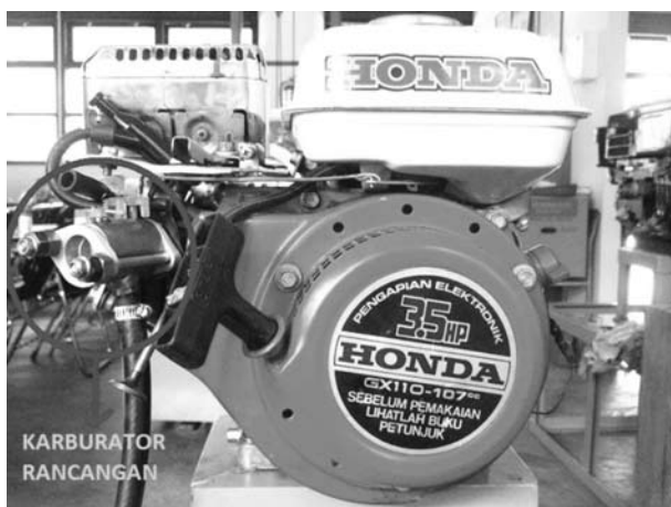
Gambar 5. Konverter biogas yang dipasang pada motor bensin
