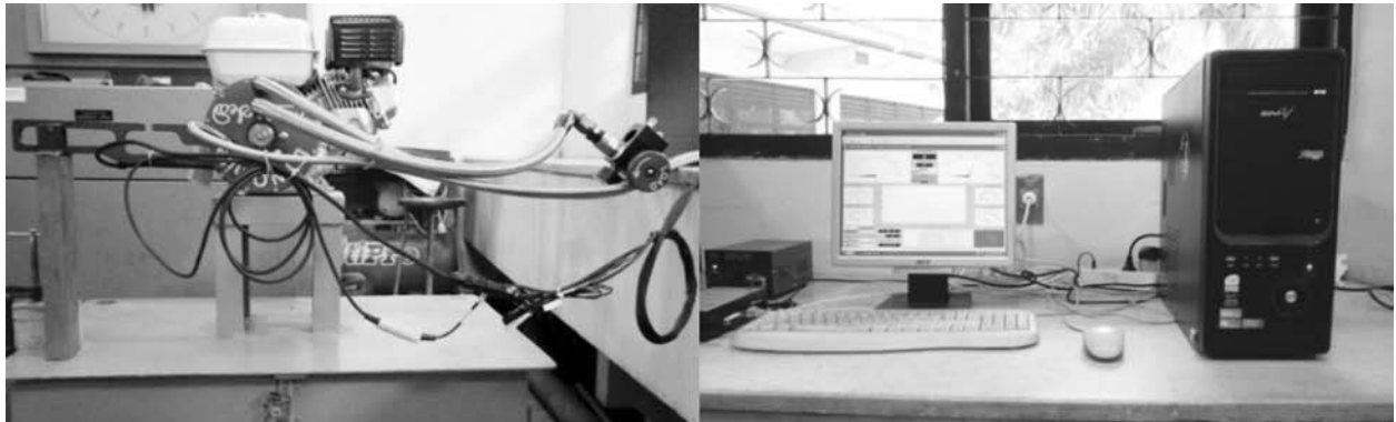
Gambar 1. Pengaturan pengujian kinerja konverter dengan dinamometer
